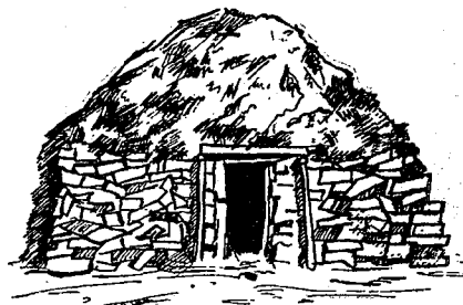
Рис. 8. Шошала (тошала), сооруженная из камня.
